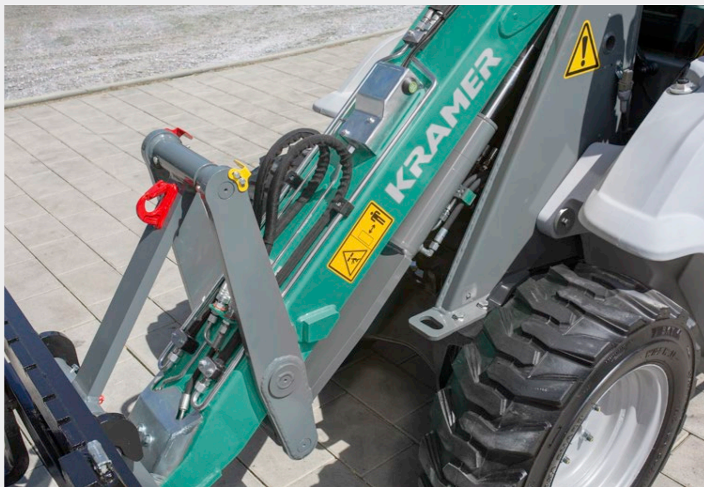
Robustní výložník se Z-kinematikou, vizuálním ukazatelem pozice nářadí a na přání se závěsným háčkem.
