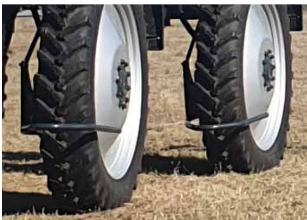
Pro MAF a speciálně pro MAF C4 je k dispozici ochrana plodin, která se přizpůsobuje proměnlivé světlé výšce.
