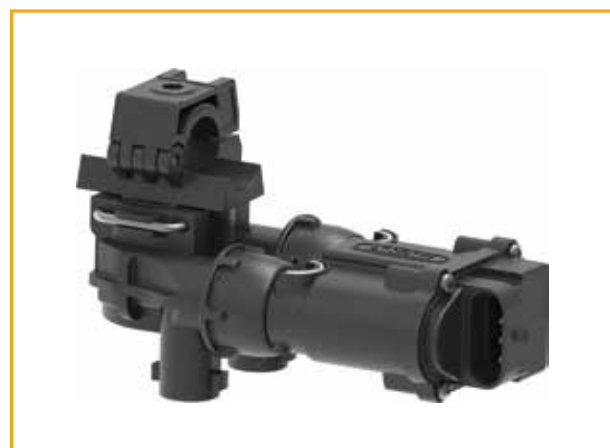
Twin Seletron zdvojnásobuje přívod z jednoduchého Seletronu od 3 do 6 l/min. Dvě trysky pracují samostatně nebo společně, aby dosáhly nejlepšího výkonu požadovanou rychlostí.
